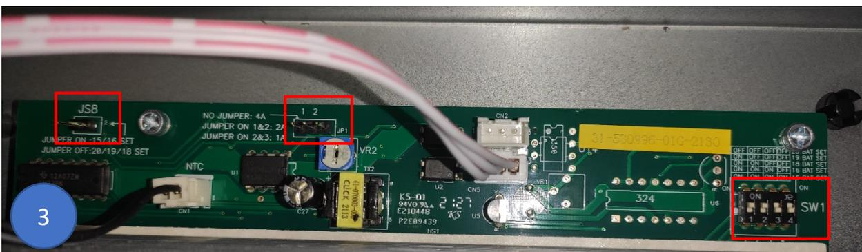
Измените положение перемычки (JS8) и переключателя (SW1) на дополнительной плате ЗУ согласно таблице 2:
